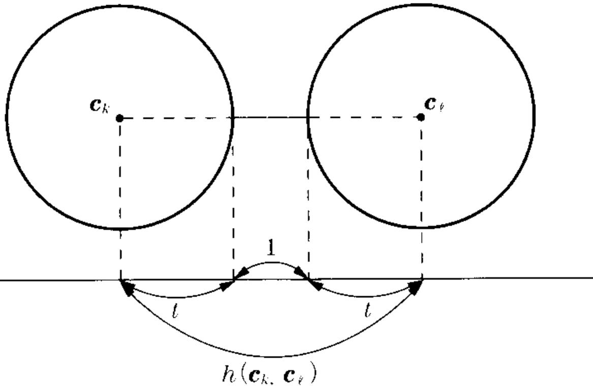
図 9.6 t 個以下の誤りの訂正原理
