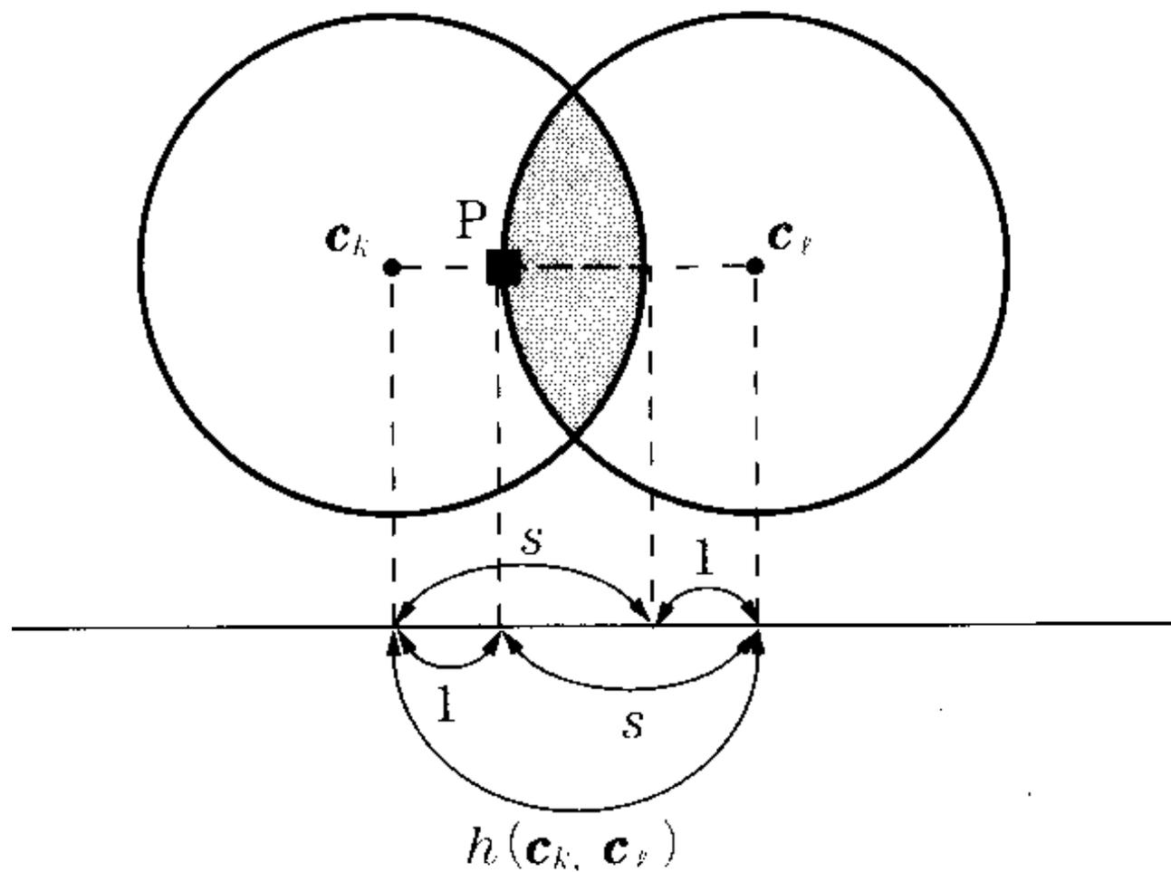
図 9.5  $s$  個以下の誤りの検出原理
