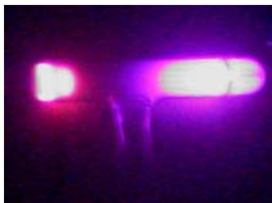
図 2：ガラス管内の様子（左：陽極、右：陰極） 管内気圧 0.6[torr]、電位差 500[V]
